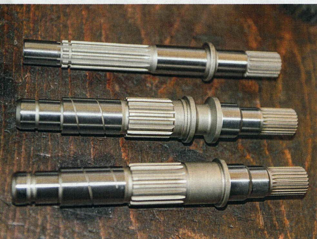
Drei modifizierte Eingangswellen für die 1150er-Boxer und frühere und spätere 1100er-Modelle
